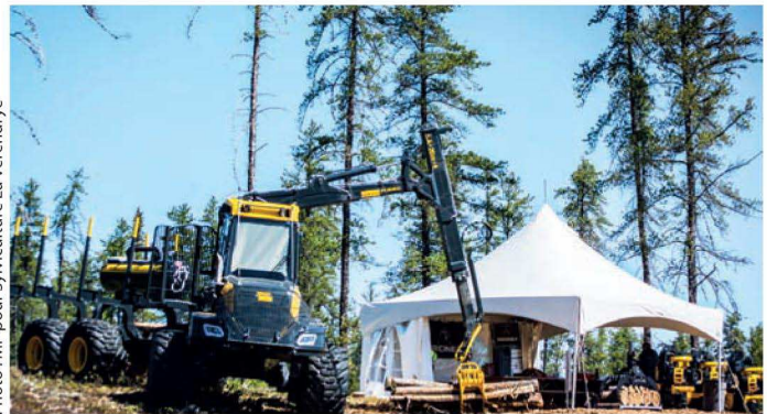
Les opérations sont géoréférencées, donc le bois abattu par l'abatteuse multifonctionnelle est localisé par l'ordinateur du transporteur. Ici, le transporteur Elephant King (2017) de Christian Roy
